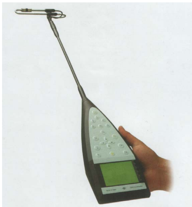
Kézi Brüel&Kjaer zajanalizátor intenzitásmérő páros szondával és a mérőszoftverrel
