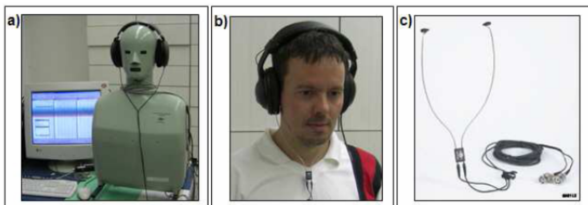
2. ábra: A BK 4128-as műfej (balra), individuális mérés (középen) és a BK 4101 binaurális mikrofonrendszer (jobbra).
