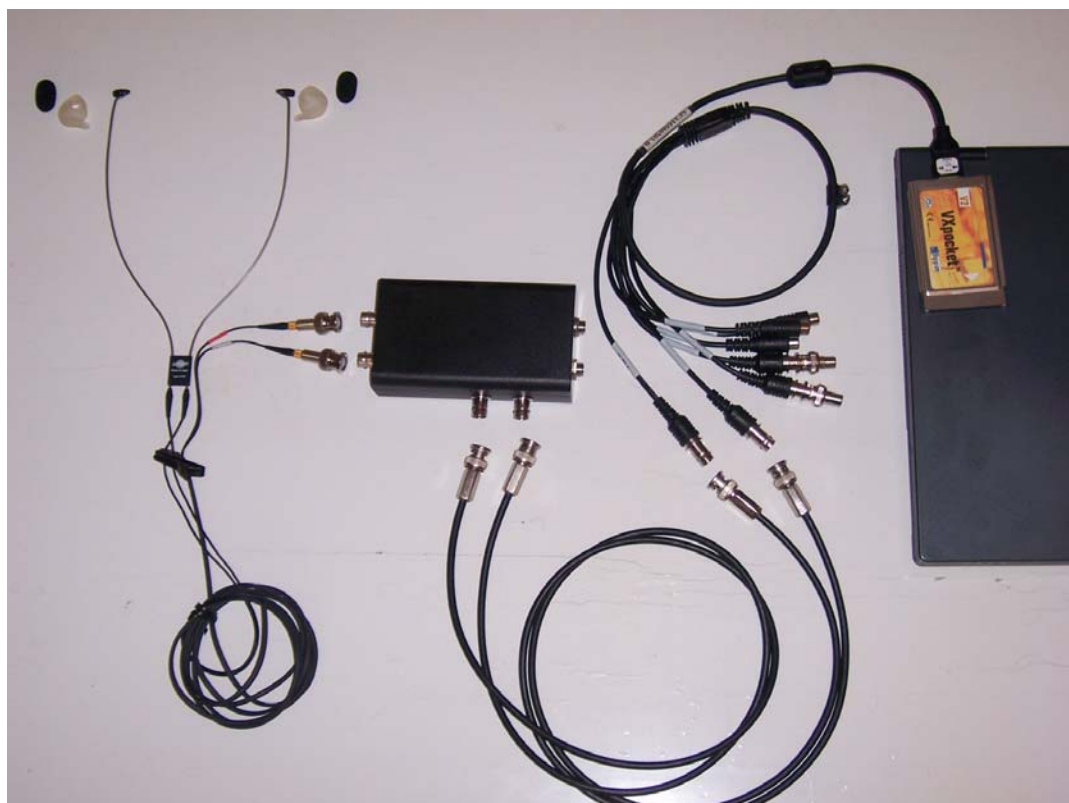
8. ábra. A BK 4101 binaurális mikrofon, a tápillesztő áramkör és a PCMCi hangkártya. A mikrofon a blokkolt hallójárat bemenetén helyezkedik el, cserélhető szivacsokkal.
