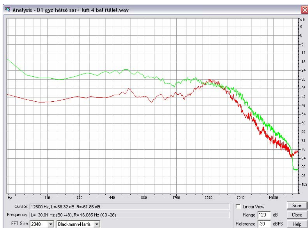
10. ábra. A D1-es terem impulzusválaszának spektruma (átviteli karakterisztikája) gömb karakterisztikájú mikrofonnal (fent) ill. binaurális felvétel során élő emberen (lent). A fülkagyló 3-4 kHz közötti megszokott, HRTF-kben is jelentkező kiemelése szembevetű. Fig. 10. Spectral representation of the response of the D1 lecture room measured with omnidirectional microphone (above) and using the binaural microphone on a real human head (below). The 3-4 kHz notch of the pinna is visible.
