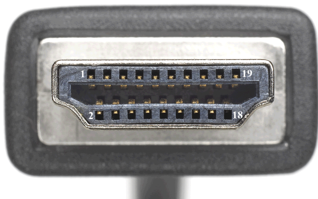
13. ábra Az „A” típusú csatlakozó lábkiosztása
