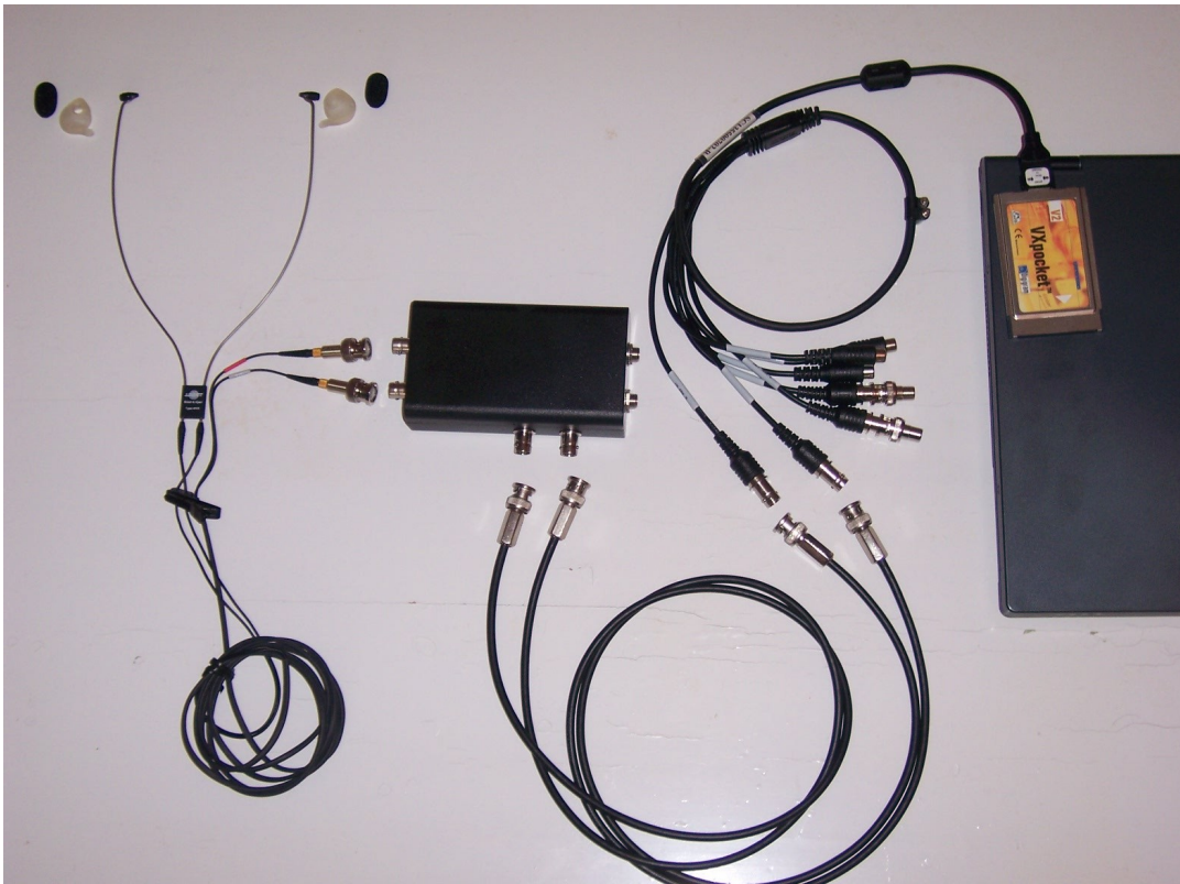
5.2.ábra: A binaurális mérőrendszer képi ábrázolása: BK4101 mikrofonok, illesztő elektronika(Tápfeszültséget adó és elosztó doboz, koaxiális kábel, hangkártya kábel), VX Pocket hangkártya és laptop, CoolEdit szoftver
