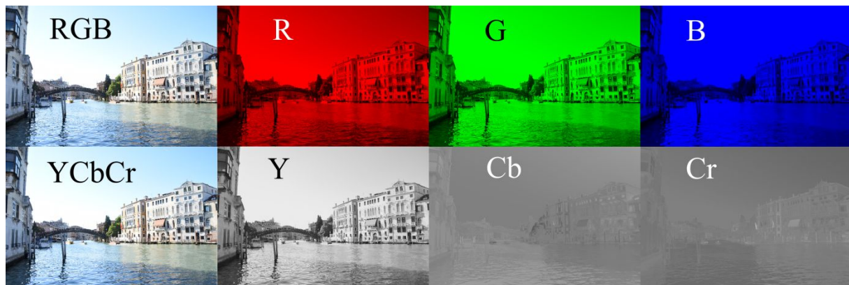
11. ábra. Háromdimenziós színtér: RGB és YCbCr színmodell
