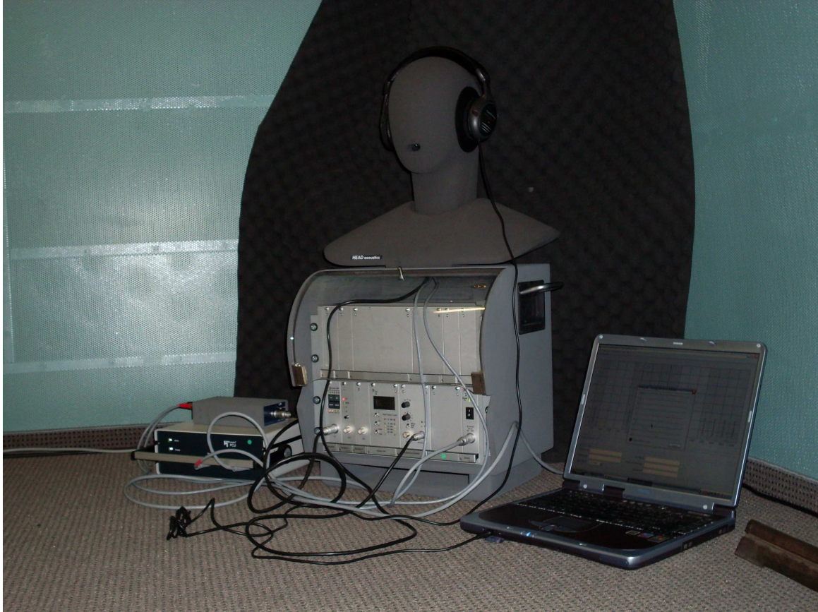
Abbildung 40: Foto der Versuchsanordnung zur Audiometerkalibrierung
