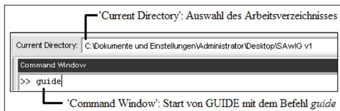
**Abbildung 4.6.1:** Auswahl des Arbeitsverzeichnisses und Starten von GUIDE unter MATLAB
