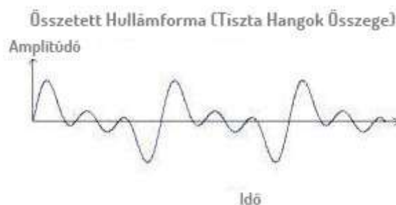
2. ábra Összetett hullámforma (tiszta hangok összege)
