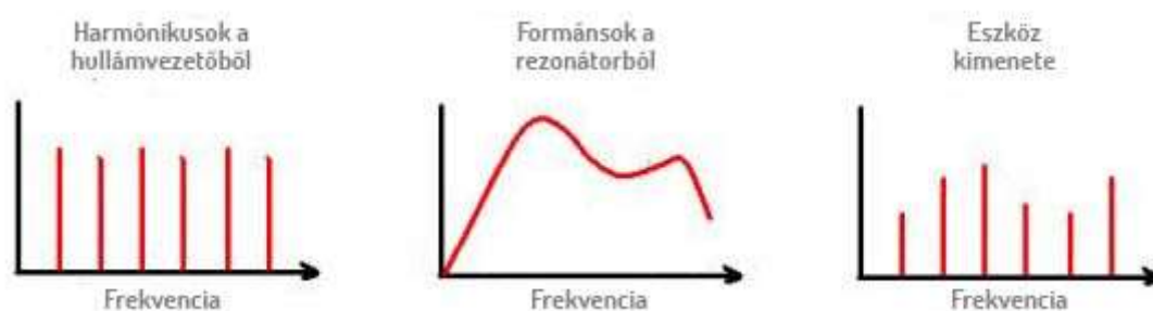
5. ábra Folyamatábra a hullámvezetőtől a hangszer kimenetéig
