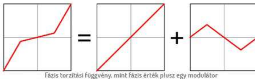
12. ábra Fázistorzítási függvény
