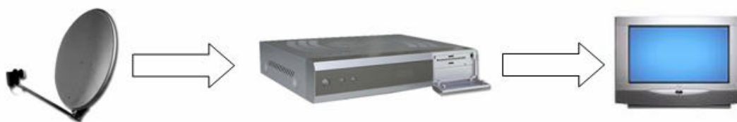
5.9 ábra: DVB-S vétele egyéni parabolaantennával
