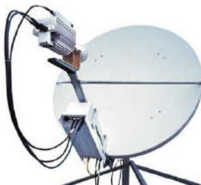
4.3 ábra: VSAT terminál
