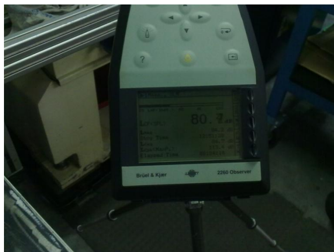
31) ábra Zajanalizátor mérés közben
