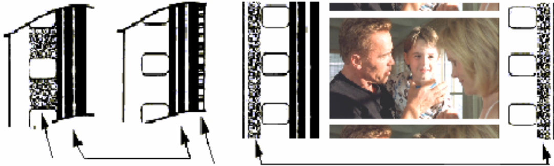
Dolby Digital – Dolby Stereo – DTS – és SDDS hangsávok 10. ábra – Egy celluloid filmkocka felépítése
