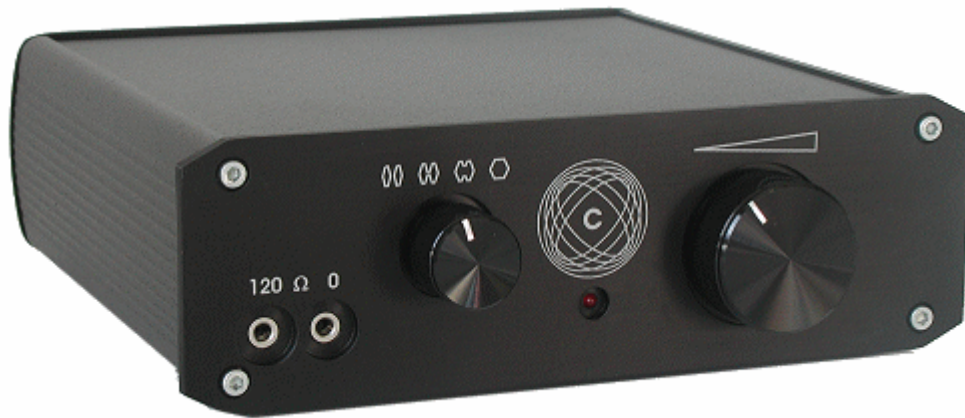
5.3. ábra fejhallgató erősítő természetes áthallással
