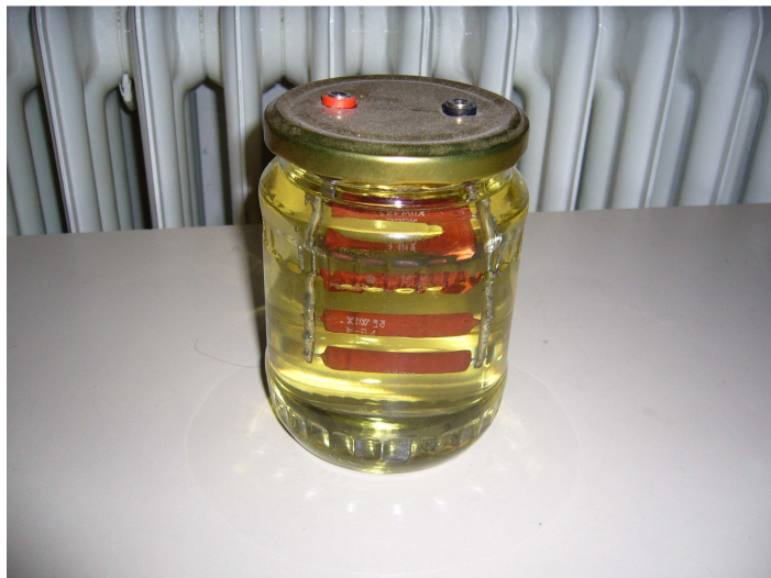
27. ábra: 6 Ohm-os műterhelés olajhűtéssel
