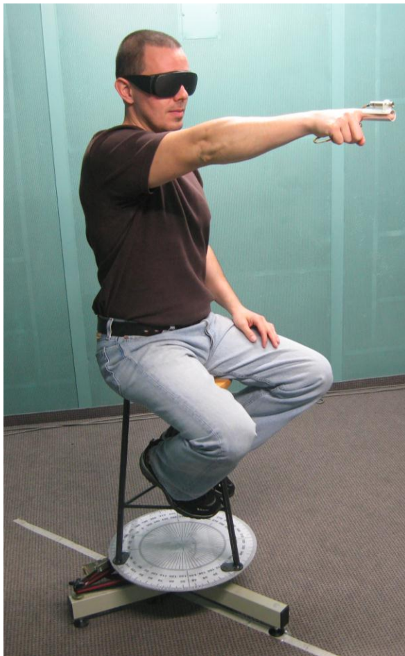
45. ábra Átalakított forgószéken végzett kísérlet a hangforrás helyének megállapítására Készítette: Répás József 2012
