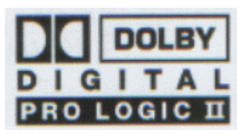
ábra. A Dolby legújabb Pro Logic II-es dekóderének logója. Ez a továbbfejlesztett dekóder képes kétcsatornás felvételtől éppúgy, mint a DS-ből többcsatornás hangot előállítani. Míg a DS Pro Logic csupán egy mono 100 – 7000 Hz-es (hátsó) surround csatornát használ, ez a dekóder két 20 – 20000 Hz-es hátsót biztosít. Ha a logón nincs rajta a „digital” szó, akkor a dekóder csak Pro Logic II-t tud, de Dolby Digital-t nem. Ha szerepel, akkor mindkettőt.
