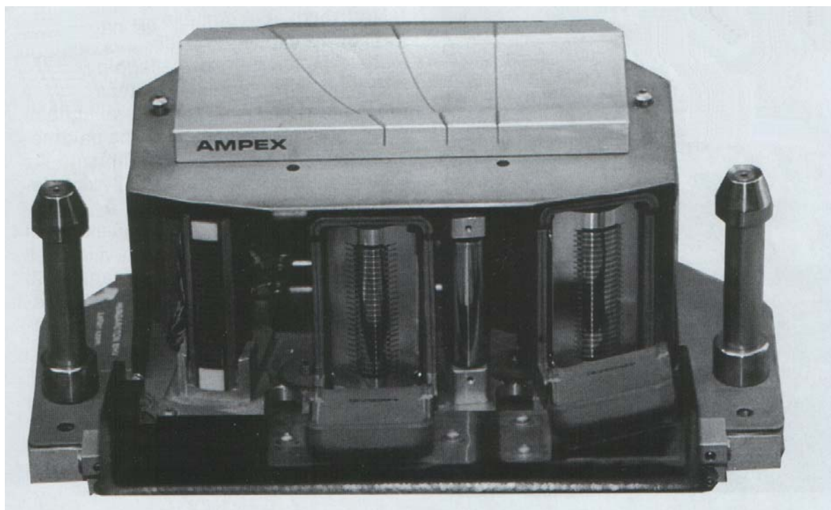
Régimódi, 24-sávós analóg Ampex magnó. Baloldalon látható a törlőfej, középen a kombinált felvevőfejek, jobbra a lejátszófejek. A felvevőfej kettős feladatú: adott sávot rögzít, a többi lejátsza (ún. szinkronfej).
