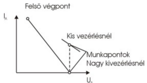
16. ábra AB osztályú végerősítő munkapontja
