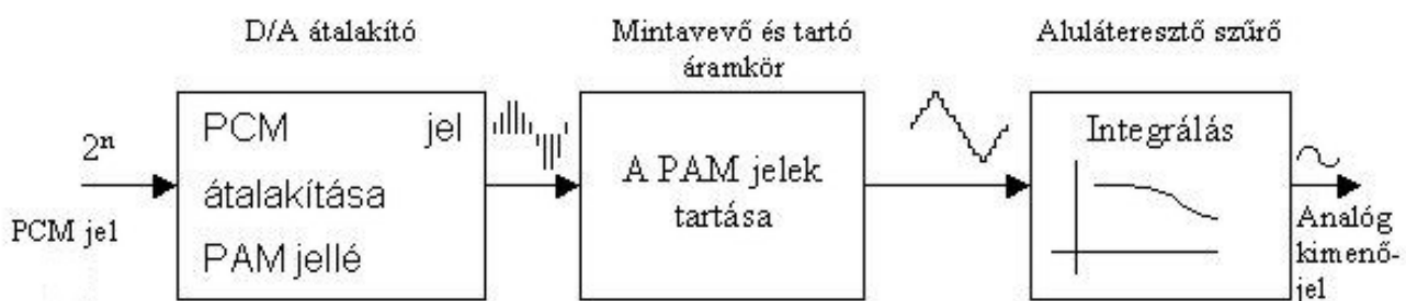
42. ábra PCM jel analóggá alakításának folyamata
