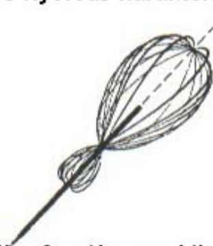
Puskamikrofon éles nyalábolású vese karakterisztikával
