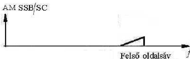
AM-DSB-ből nyert AM-SSB/SC jel szűréssel.
